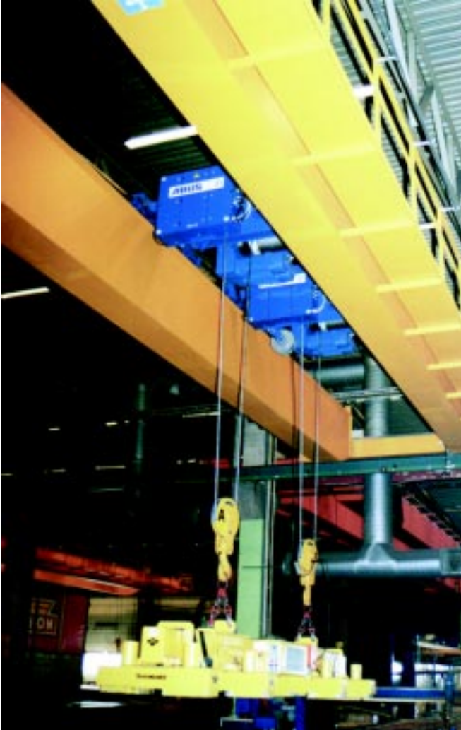
Det justerbara lyftoket (Tecnomagnete) lyfter plåtarna med fyra elektropermanentmagneter.
